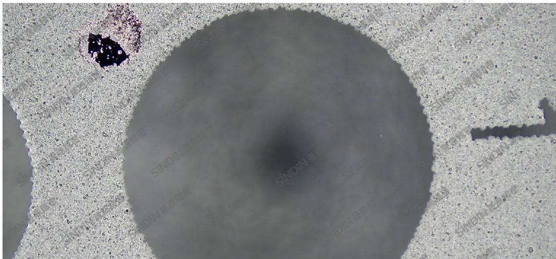
样品二 USC 处理前显微 50 倍观察的产品表面
